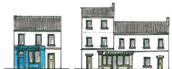
Deux exemples de mauvaise insertion de la devanture dans la façade de l'immeuble. On voit que la limite de l'étage n'est pas respectée dans le croquis de gauche, tandis que celui de droite montre une devanture qui ne fait pas de distinction entre deux façades différentes.
