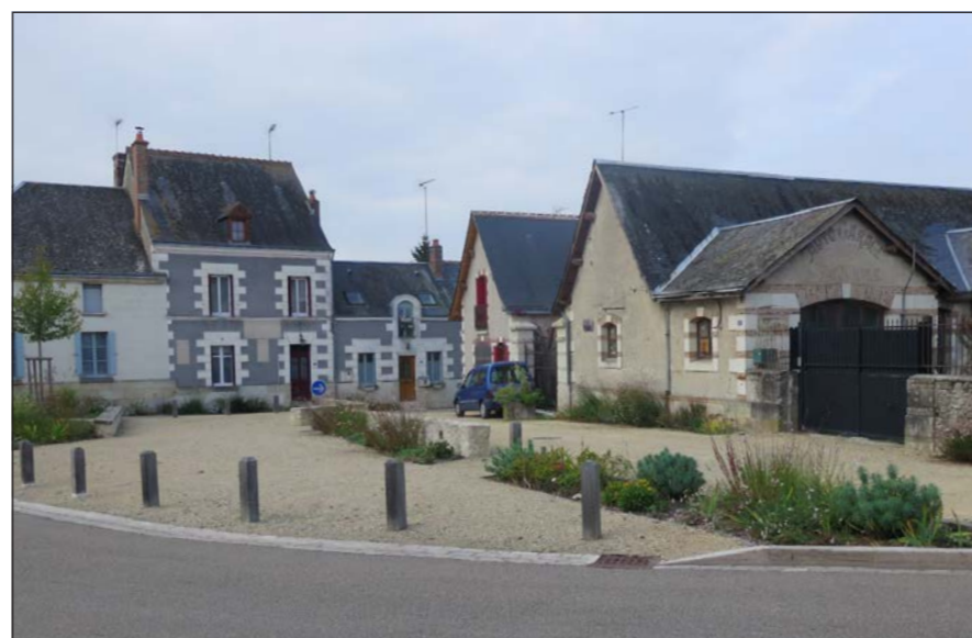
Fig.11 : Simplicité des matériaux et revêtements, mobiliers (bornes bois, banquettes sur muret) limités à leurs usages, place de la voiture cadrée, végétation permettant l'infiltration des eaux pluviales : une conception globale. Place de la mairie, Le Louroux (37) (src. extrait du règlement écrit du PSMV de Loches - Pièce 2.1)
