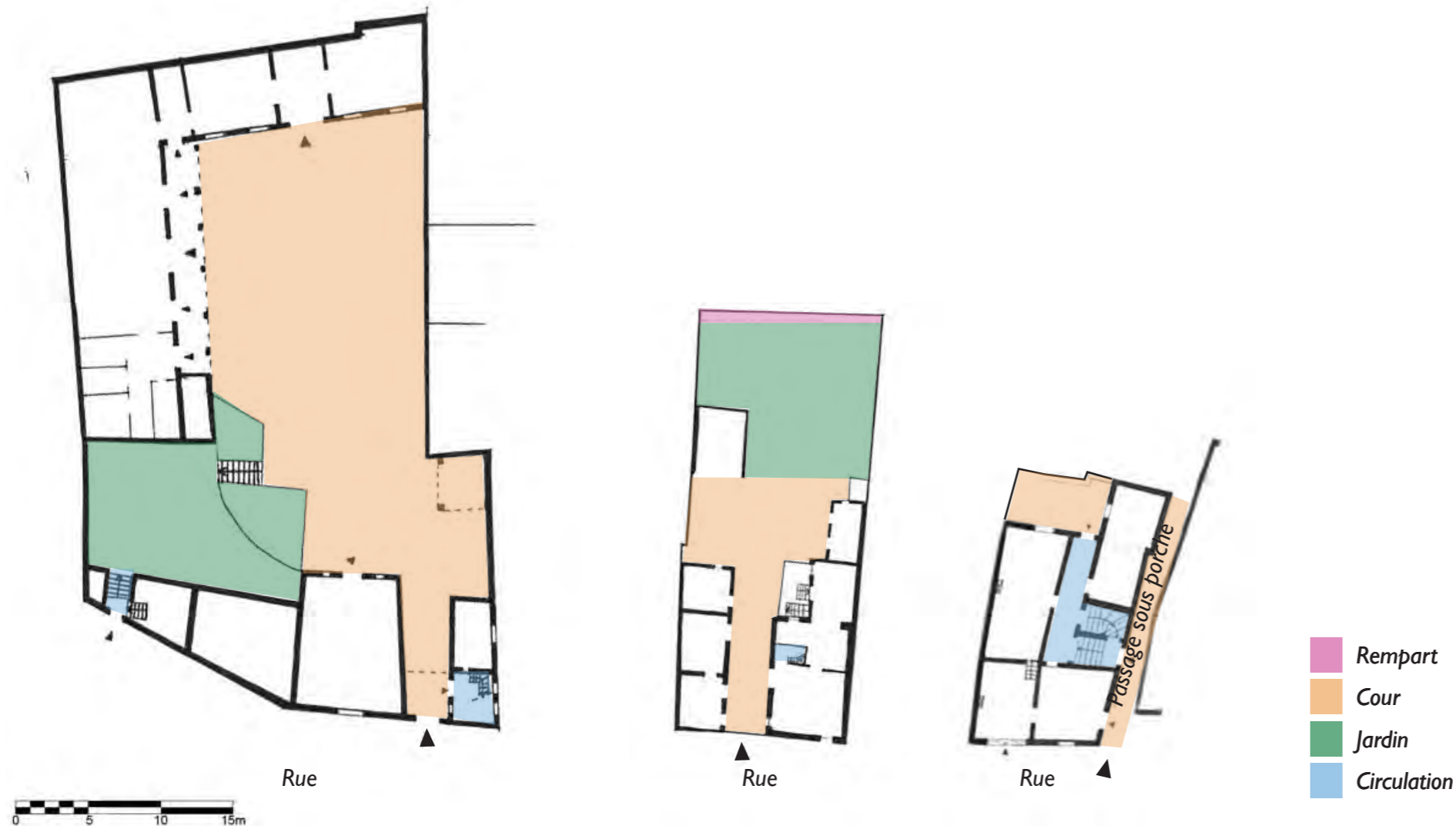
Fig.849 : Plans rez-de-chaussée des maisons avec porche
