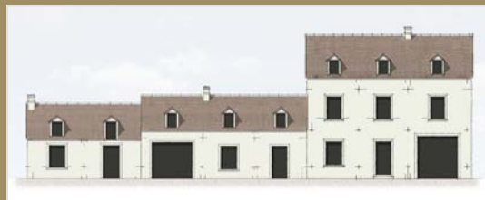
Ordonnements des ouvertures sur des constructions principales à couronnements variés
