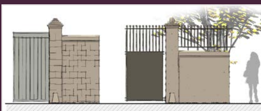
Typologie des murs de clôture et piliers
